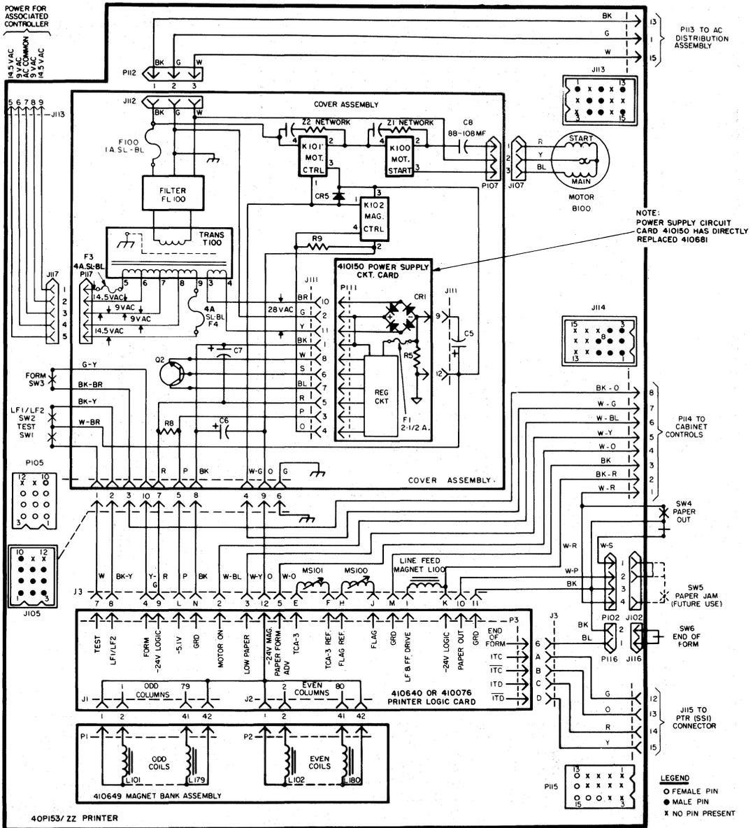
Fig. 11—40P153 Tractor Feed Printer
